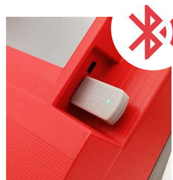
Puerto USB Bluetooth para programar a través de la aplicación Android
